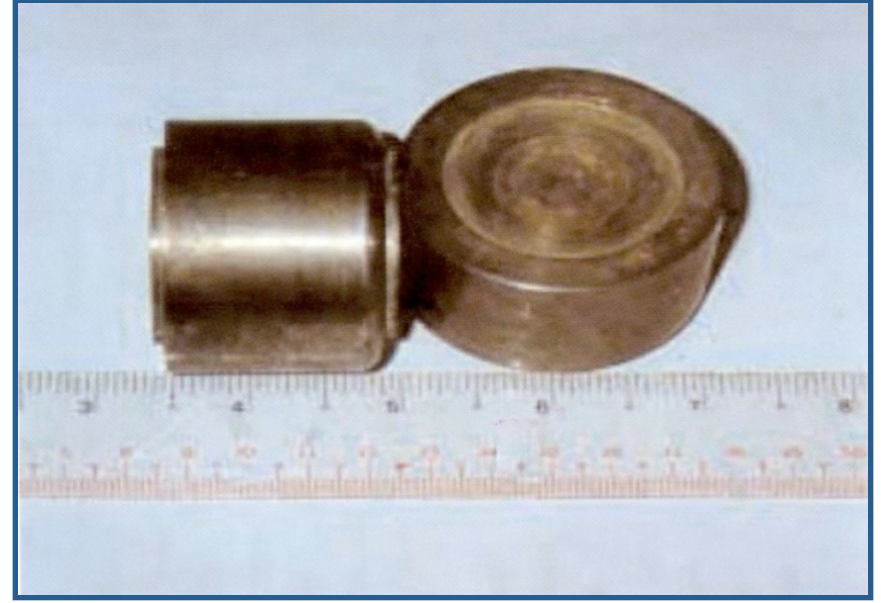
Sorgente radioattiva per radioterapia esterna. Come si nota, la dimensione è assai ridotta.
